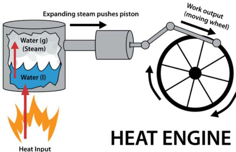
Түлшний дотоод энэргийг механик энерги болгон хувиргадаг төхөөрөмжийг дулааны машин гэдэг. Дулааны машин нь:
